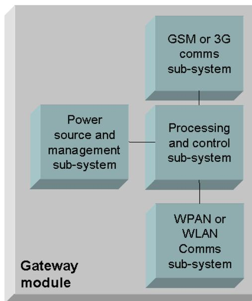
Figure 9 : Gateway Module Generic Architecture
